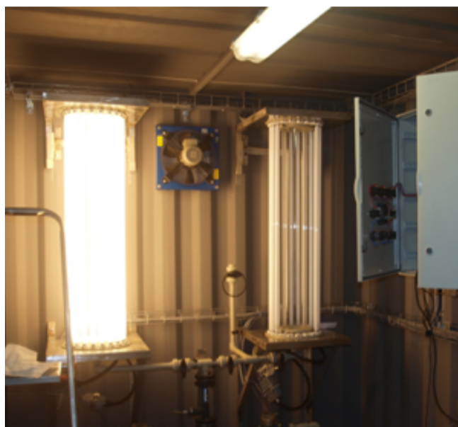
■ Fotoreaktory s UV zářivkami v kontejneru pilotního zařízení. Levý reaktor je pro názornost rozsvícen, při provozu technologie jsou však oba uzavřeny nerezovou kapotou.
