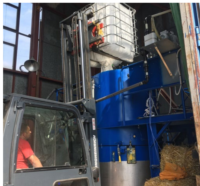
Plnění reaktoru pomocí vysokozdvizného vozíku
