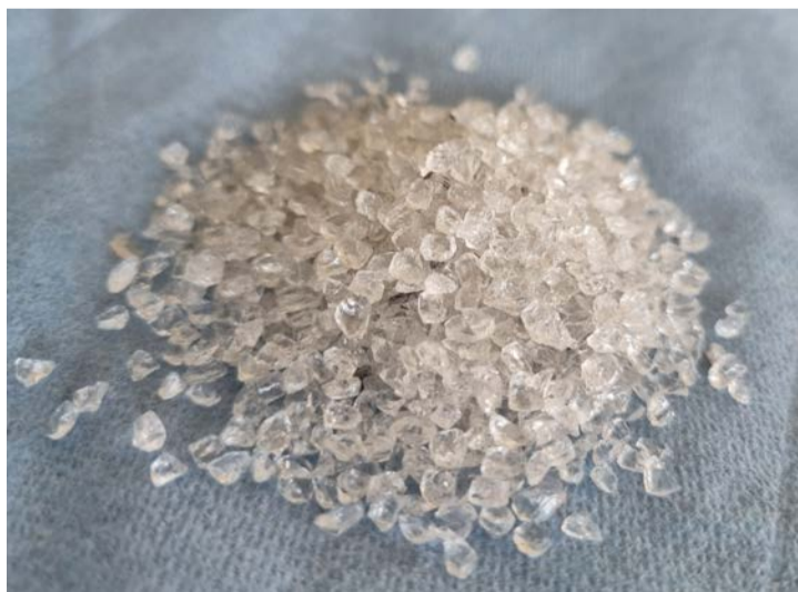
Separované sklo z fotovoltaického panelu
