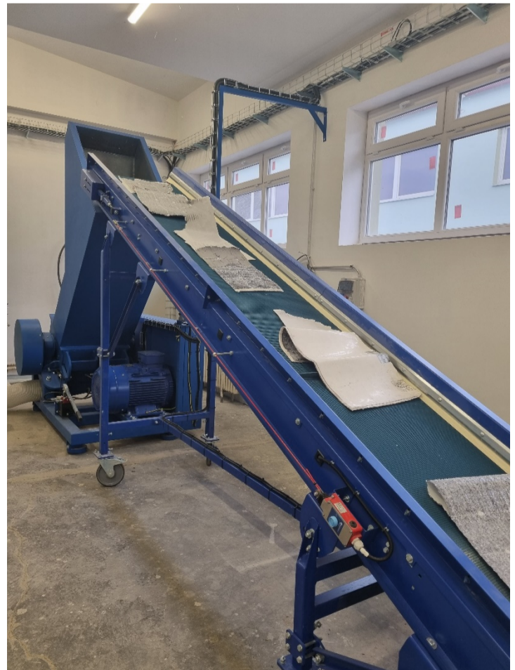
Zařízení pro dezintegraci fotovoltaických panelů
