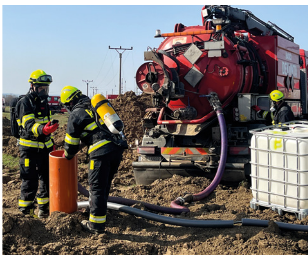
Odčerpávání čistého benzenu do specializované cisterny na nebezpečné odpady jednotky Hasiči Dekonta
