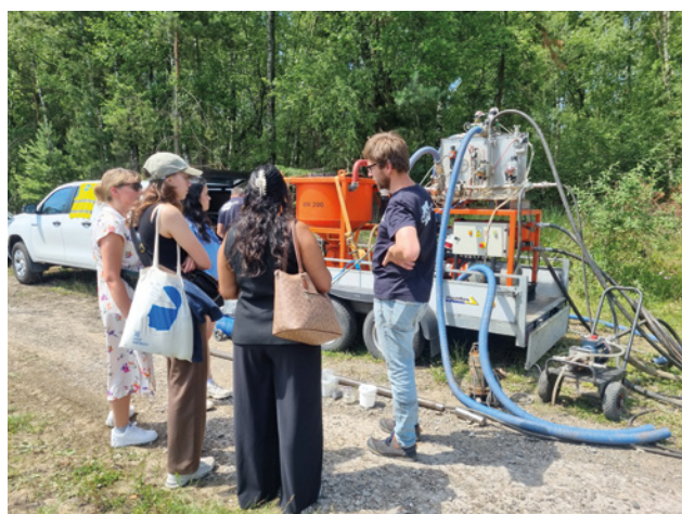
Praktická ukázka zařízení pro FRAC-IN injektáže
